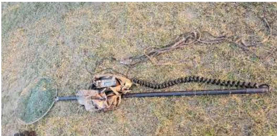
Fig. 68. Pescuitul științific cu anodul purtat prin apă cu agregat portabil pe acumulatori
